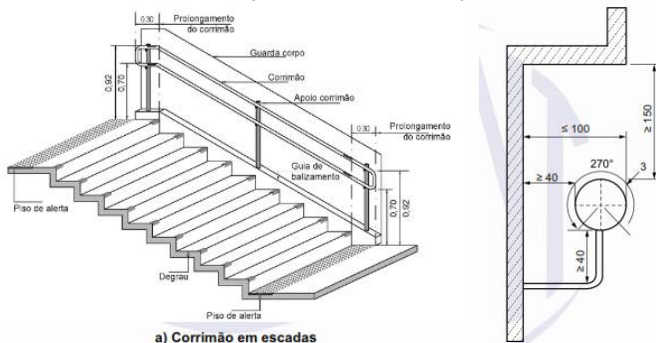
a) Corrimão em escadas
